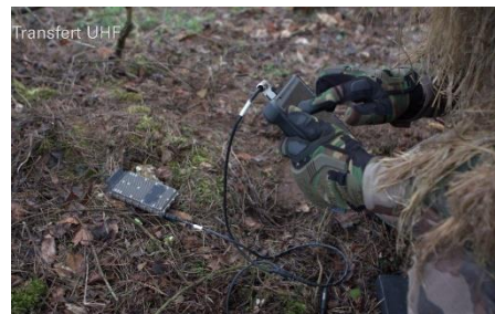
Fig. 8. L'IHM permet de consulter la base des évènements archivée dans Sentinelle via une connexion IP filaire ou IP UHF.
