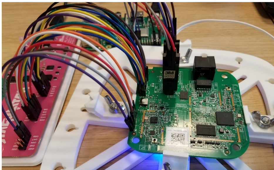
Figure 1. Principe d'extraction de micro-logiciels avec notamment une sonde "JTAGulator" permettant de découvrir la structure des ports JTAG et Série ainsi que l'utilisation d'une pince de programmation pour extraire le contenu d'une mémoire SPI.
